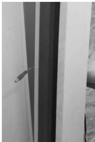
2. Sklopeným oknem protáhněte konektor směrem ven.
