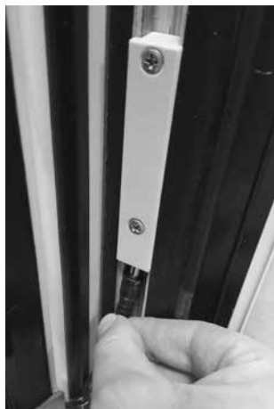
4. Konektor zasuňte do dobíjecí zdičky, okno zavřete a nabíječku připojte k zásuvce.
